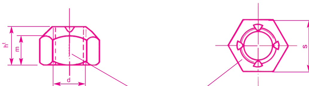
Marcação da classe qualidade e da sigla do fabricante segundo a norma ISO 2320
