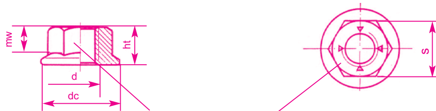
Marcação da classe qualidade e da sigla do fabricante segundo a norma ISO 2320.
