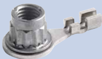
ÉCROU 12 PANS AUTOFREINÉ AVEC COSSE SERTIE
